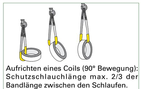
Aufrichten eines Coils (90° Bewegung): Schutzschlauchlänge max. 2/3 der Bandlänge zwischen den Schlaufen.
